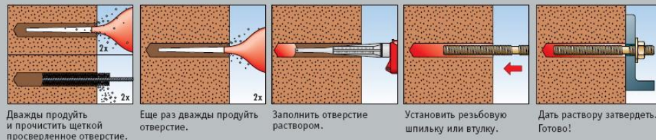
Пример анкеровки без использования анкерной гильзы
