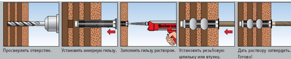
Пример анкеровки с использованием анкерной гильзы
