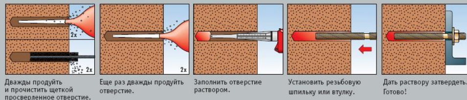
Пример анкеровки без использования анкерной гильзы
